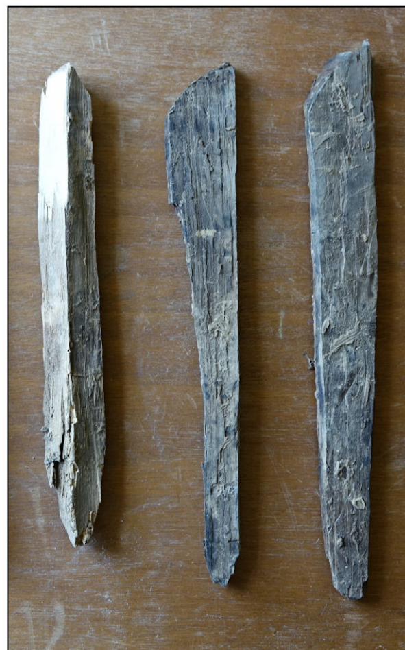
Fig. 3.6. Eclisses du torchis (peuplier et chêne)
